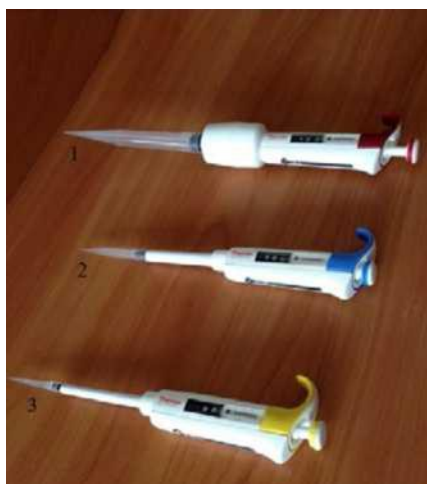
Рис. 5. Пипетки дозаторы одноканальные переменного объёма: 1 — 110 мл; 2 — 100—1000 мкл; 3 — 10—100
